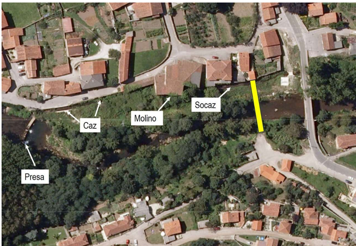
Figura 6. Molino que se encuentra aguas arriba de los dos puentes y cuyo socaz desagua por debajo de los vanos cortos que presentan sendas estructuras (mapas.cantabria 2007 y textos de LVC).
